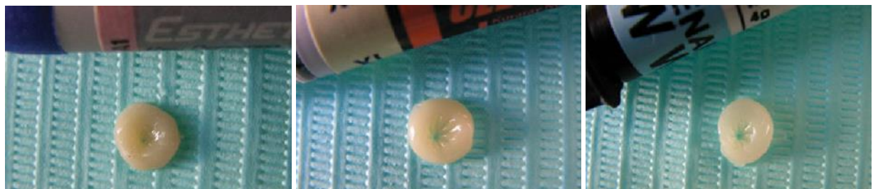
Рис. 4. Оттиски образцов различных композитных материалов одинаковой величины и диаметра, сформированные при помощи матриц SuperMat (KERR)
